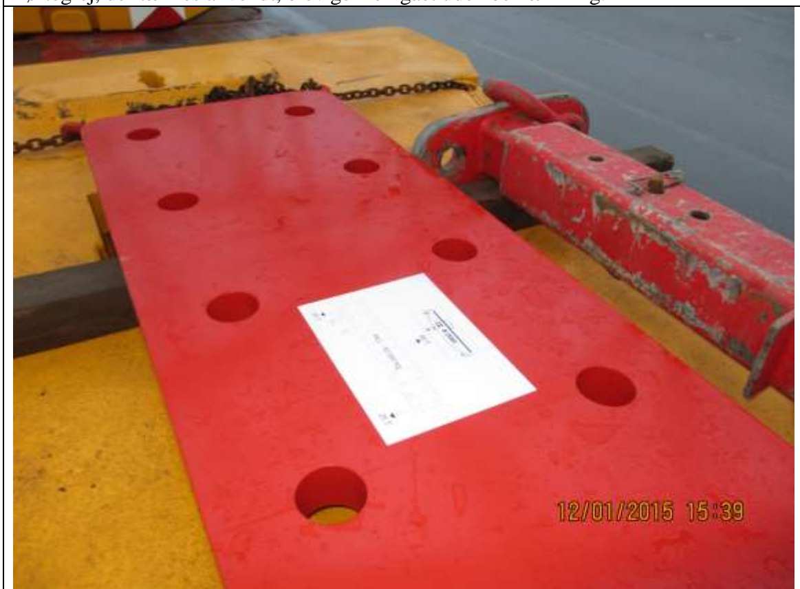
Løfteåg SWL 50 m.t. har en maksimal spredning på 3650 mm, hvilket skønnes velegnet.
