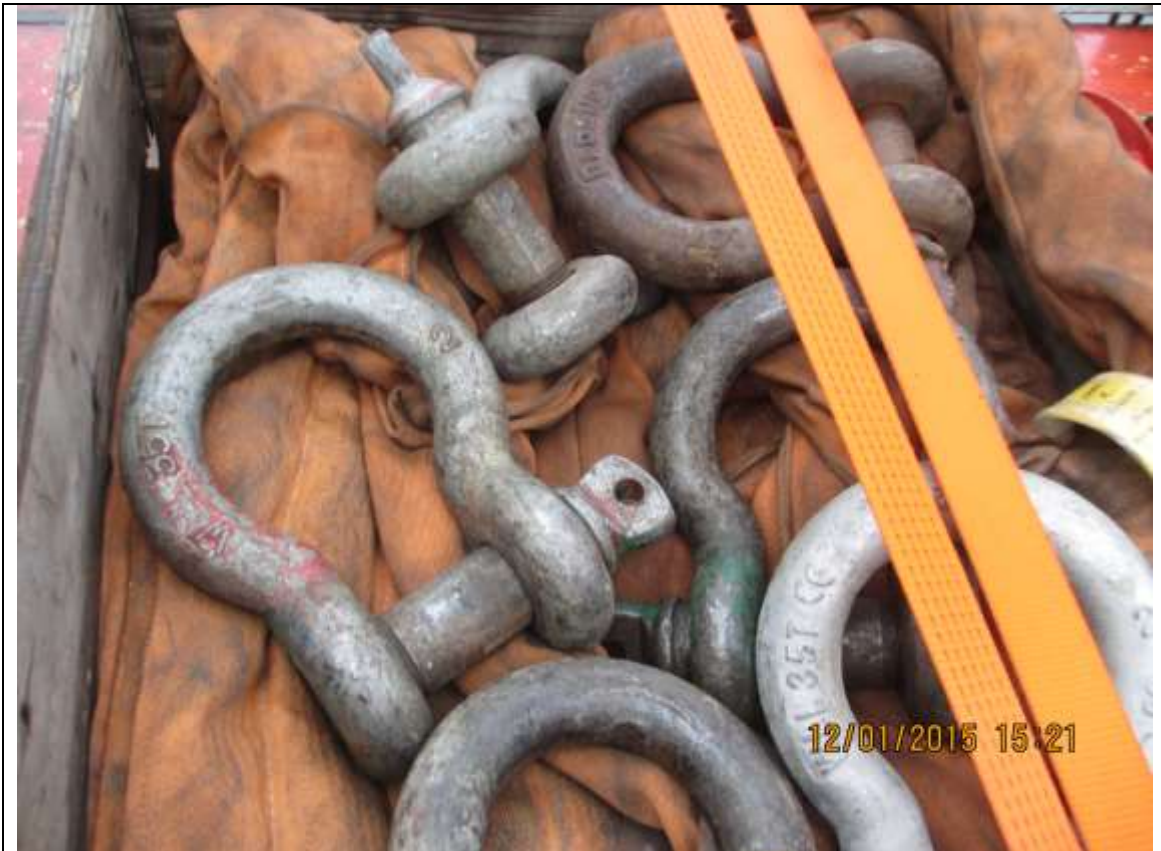
Der hugges an med sjækler SWL 35 m.t. mellem slæng og åg samt åg og blok.
